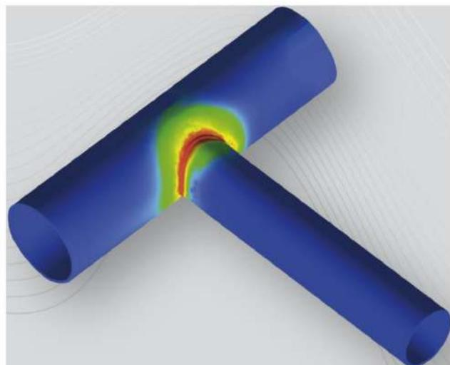
Комбинируя Simufact.welding с Simufact.forming можно моделировать различные производственные цепочки. Таким образом, процессы сварки могут быть эффективно интегрированы в процесс численного моделирования всего производственного процесса. Простая передача данных между пакетами позволяет не только принимать во внимание историю обработки металла давлением, но также проводить анализ прочности при моделировании сварных швов.
