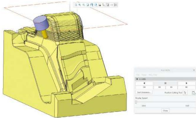
Последовательность черновой обработки при высокоскоростном фрезеровании, многопоточность для быстрых вычислений.
