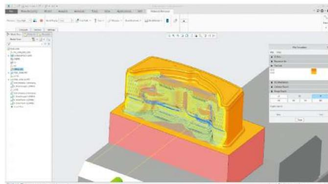
Моделирование удаления материала при высокоскоростном фрезеровании
