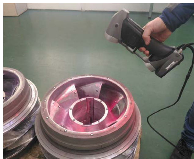
Рис. 23. Применение 3D-сканера для создания 3D-модели «рабочего колеса»
