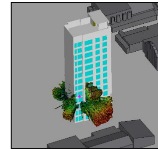
Излучение антенны в миллиметровом диапазоне внутри здания
