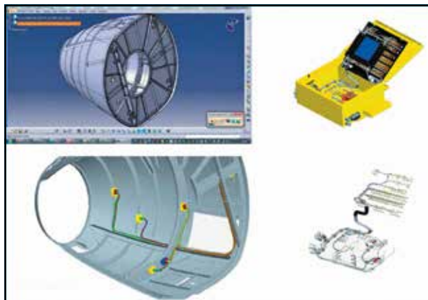
Пример гетерогенного проектирования электрики в Creo Cabling
