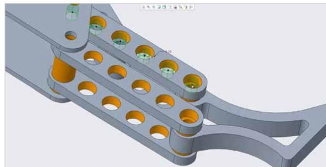
Гибкое моделирование помогает быстро доводить геометрию до нужного состояния путем перетаскивания с помощью трехмерного указателя.
