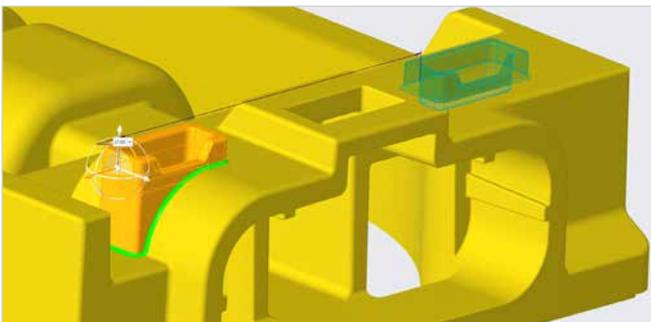
Гибкое моделирование помогает быстро доводить геометрию до нужного состояния путем перетаскивания с помощью трехмерного указателя.
