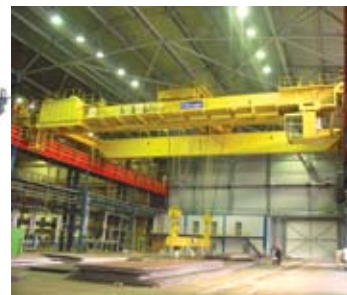
Кран мостовой металлургический. Проект в Pro/ENGINEER и его реализация в металле.
