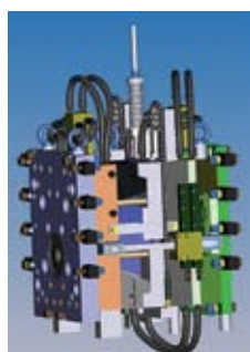
Пресс-форма для литья под давлением отливок из алюминиевых сплавов со сложной кинематикой и системой охлаждения
